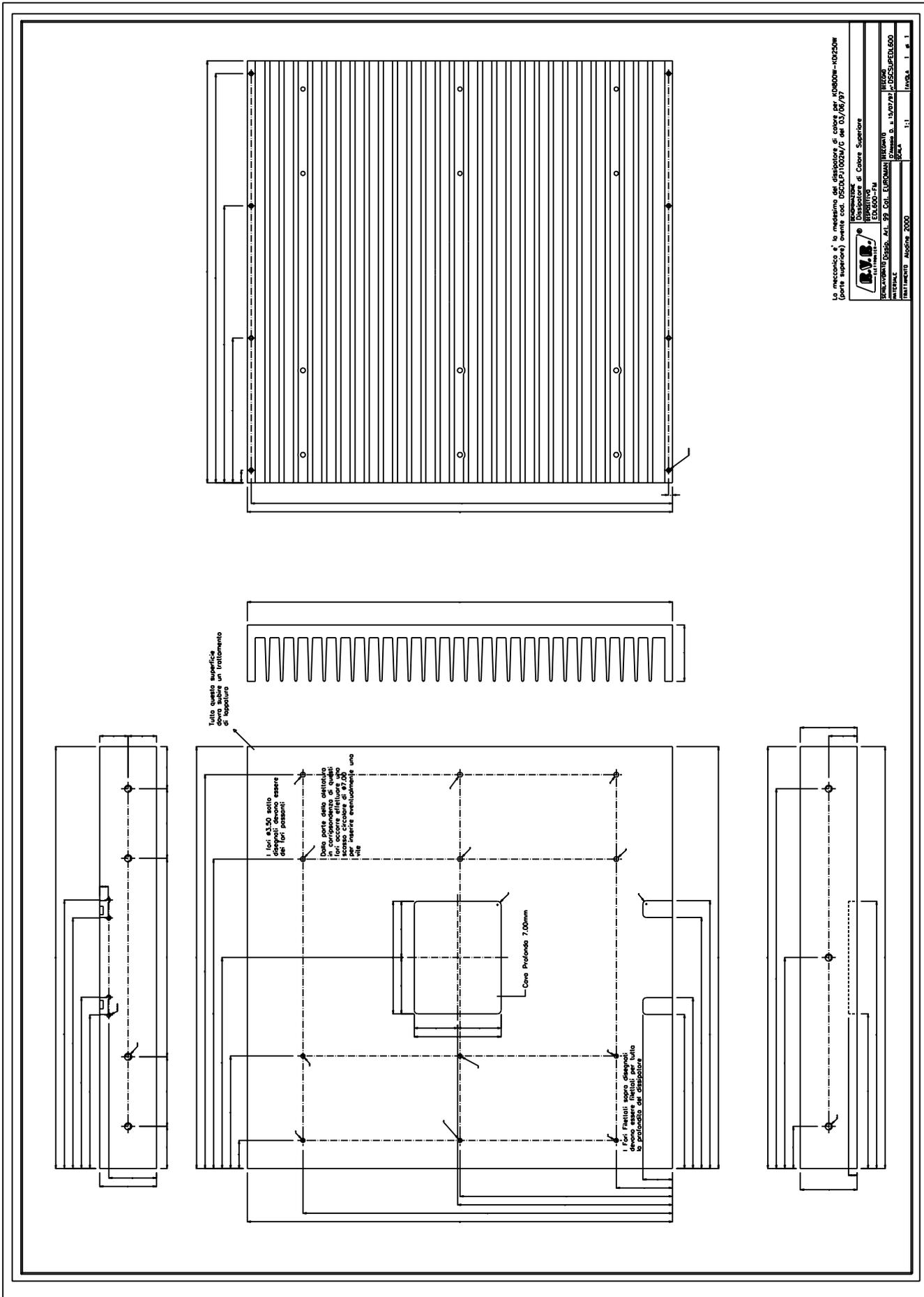
Lo spessore "a" in relazione del dissipatore di calore per 40000W-10020W
