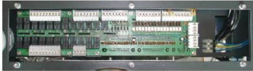
Figura 7-13 L'interfaccia parallela
